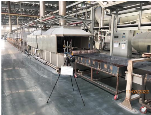
พื้นที่บริเวณเตาให้ความร้อนของกระบวนการ Intermediate Heat Treatment (H1)
